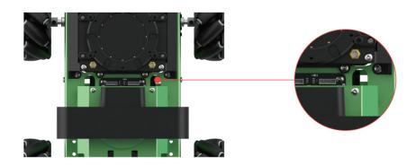
4 将3D深度相机穿出的连接线接到Jetson主板②号接口。
