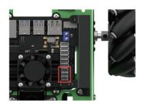
3 把机械臂上的单目相机USB线接到Jetson主板的①号接口。
