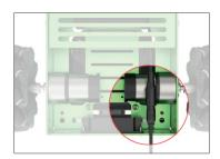
4 可通过查看充电器上的指示灯了解充电状态。红色表示充电中,绿色表示充电完成。充电时长约为4个小时,充电完成后请及时将充电器拔下,避免过度充电。
