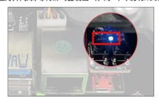
③ 设备出厂默认为AP直连模式,开机成功后,会产生一个以"HW"开头的热点,首次连接时需输入密码"hiwonder"。
